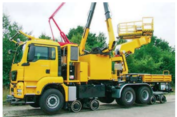
Oberleitungsmontagefahrzeuge von SRT – Schörling Rail Tech sind Eigenentwicklungen. Foto: SRT
