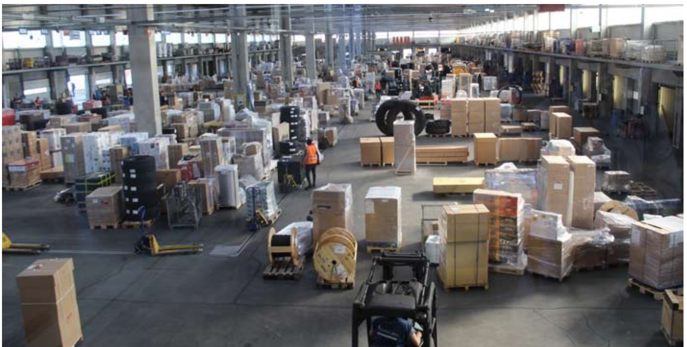
In der Umschlaghalle sorgen zwei Unterflurketten zur Bewegung von 80 Hubwagen zur Warenbeförderung dafür, dass Elektrostapler ihre Fracht in 35 Ladestationen abliefern können. Aus Sicherheitsgründen verfügt das Terminal über 145 Kameras im Innen- und Außenbereich.
