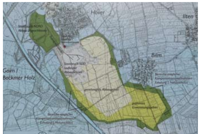
Links oben im Nordwesten das abgeschlossene Abbaugbiet (der alte Bruch), südlich davon das laufende und noch weiter darunter das bereits genehmigte Abbaugbiet. Das geplante Erweiterungsgebiet bis zum Jahr 2050 ist südlich von Bilm hellgrün gekennzeichnet.
